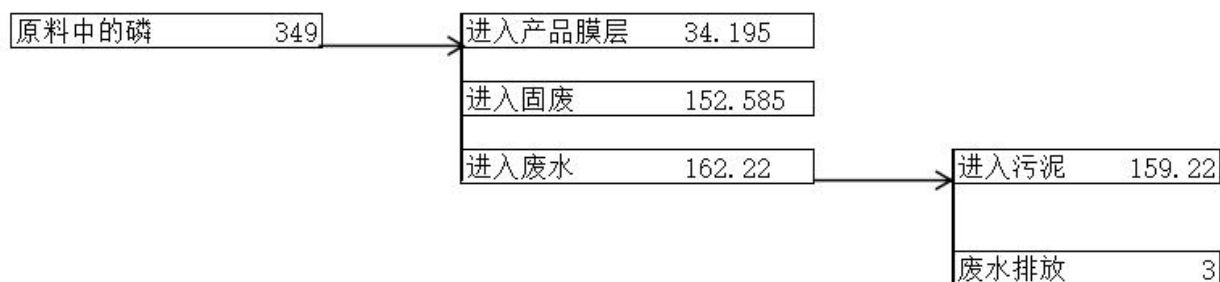
图 2.5-2 项目磷酸盐物料平衡图 单位：kg/a
