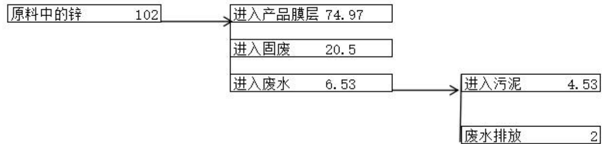
图 2.5-3 项目总锌物料平衡图 单位: kg/a
