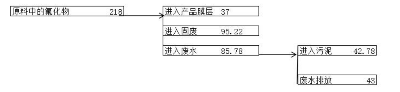
图 2.5-4 项目氟化物物料平衡图 单位：kg/a
