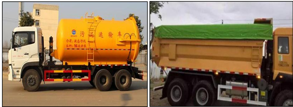
图 2.2-1 专用密闭罐车、密闭运输车
