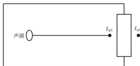
图 4.3-1 室内声源等效为室外声源图例
